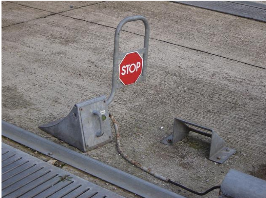
Foto 1: veiligheidssysteem om de positie van de vrachtwagens te borgen die opgesteld staan om geladen te worden aan de laadkade. Een gekoppeld alarmsysteem moet het personeel van SKF dat de vrachtwagen aan het laden is, waarschuwen zodra de vrachtwagen de veilige positie verlaat.
