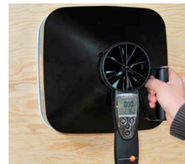
9 | Anemometer die voorzien is van een conus en een vleugelrad.
