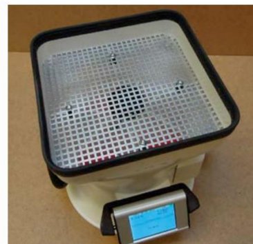
9 | Anemometer die voorzien is van een conus en een vleugelrad.
