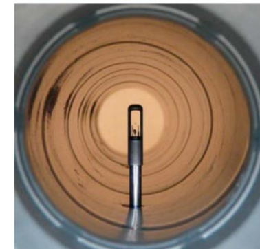
11 | Gebruik van een kleine sonde in een cirkelvormig kanaal.
